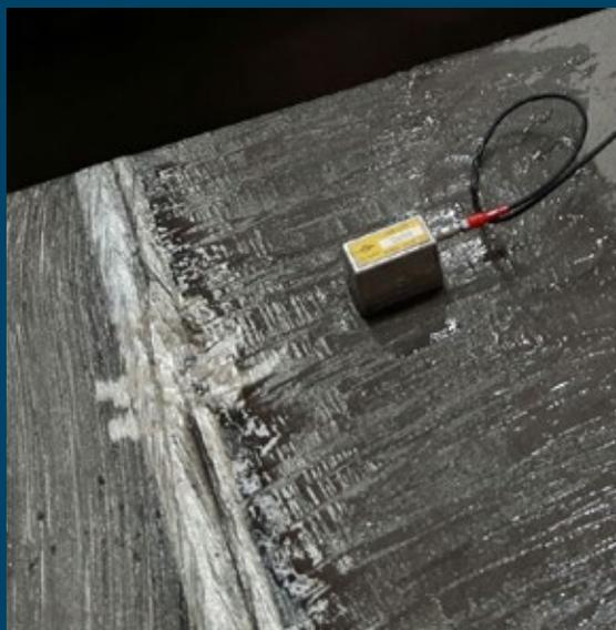
Hochpräzise Messung von Fehlstellen auch bei geringer Größe und tief innerhalb der Materialstruktur.
