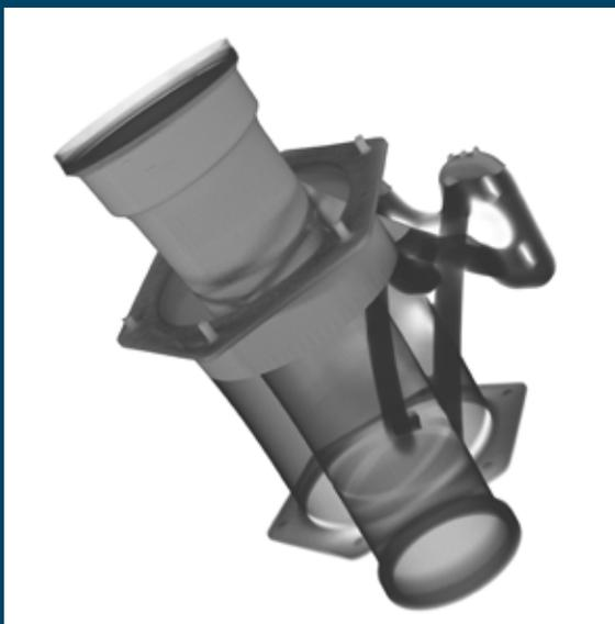
Hochaufgelöste Fehlererkennung in und an Bauteilen mit komplexer Geometrie.
