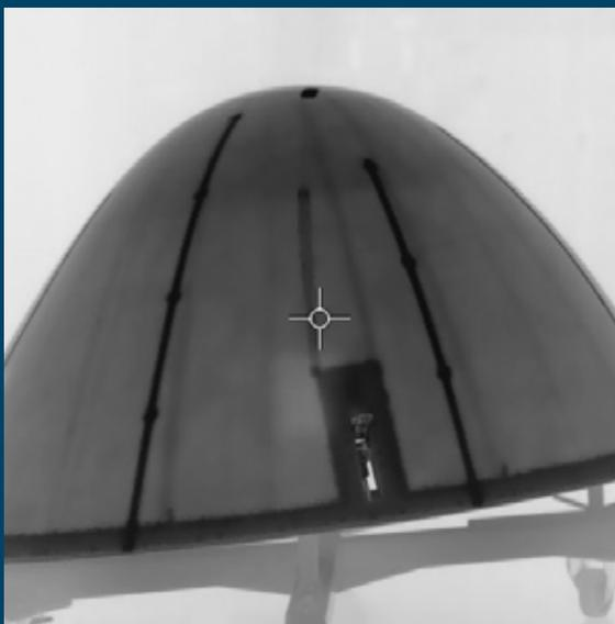
Prüfung auf Delaminierungen und Risse unter der Materialoberfläche; Erkennen von Unstetigkeiten (unterschiedliche Dicke), Reparaturstellen, Überlackierungen und versteckten Teilen sowie Wassereintrich.
